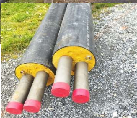
canalisations de tuyaux d'eau chaude, pression 4 bars et 90°.
